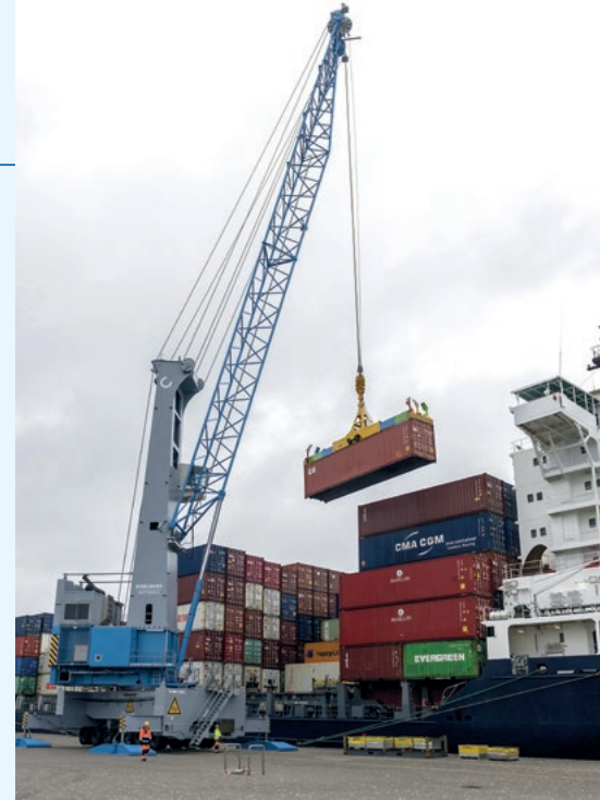
Den mobile containerkran har en løftekapacitet på 125 ton og en svingradius på 51 meter.
